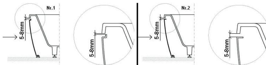
Установите сантехнику на предназначенное для нее место. В соответствии с измеренной высотой декоративной панели определите высоту сантехники так, чтобы высота под краем ванны была такой же, как высота панели плюс 5-8 мм (если предусмотрена панель).
