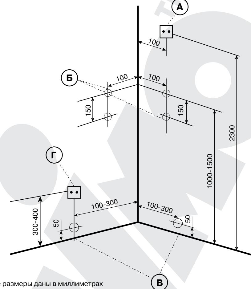
**А.** Розетка электрическая с заземлением 220-240V, 50Hz
